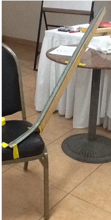
Yon pis encline ou ka bati nan klas la pou etid transfòmasyon enèji. Ou ka woule yon mab sòti an wo pis la al atè.
